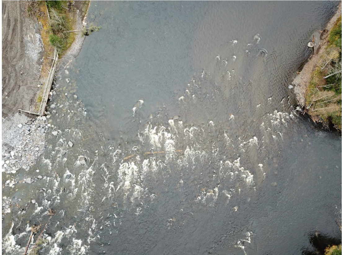
Figur 3. Flygbilden visar läget där den tidigare överfallsdammen var anlagd. De kvarvarande betongdelarna är synliga i mitten av bilden.
