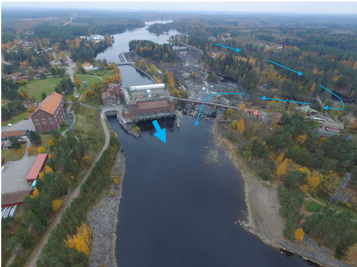
Figur 14. Målet med utformning av fiskpassager och flödesregim i Kungsådran är att säkerställa en god anlockning och passageeffektivitet för uppvandrande fisk som söker sig till det dominerande flödet från kraftverkets utloppskanal. Norconsult 2017.
