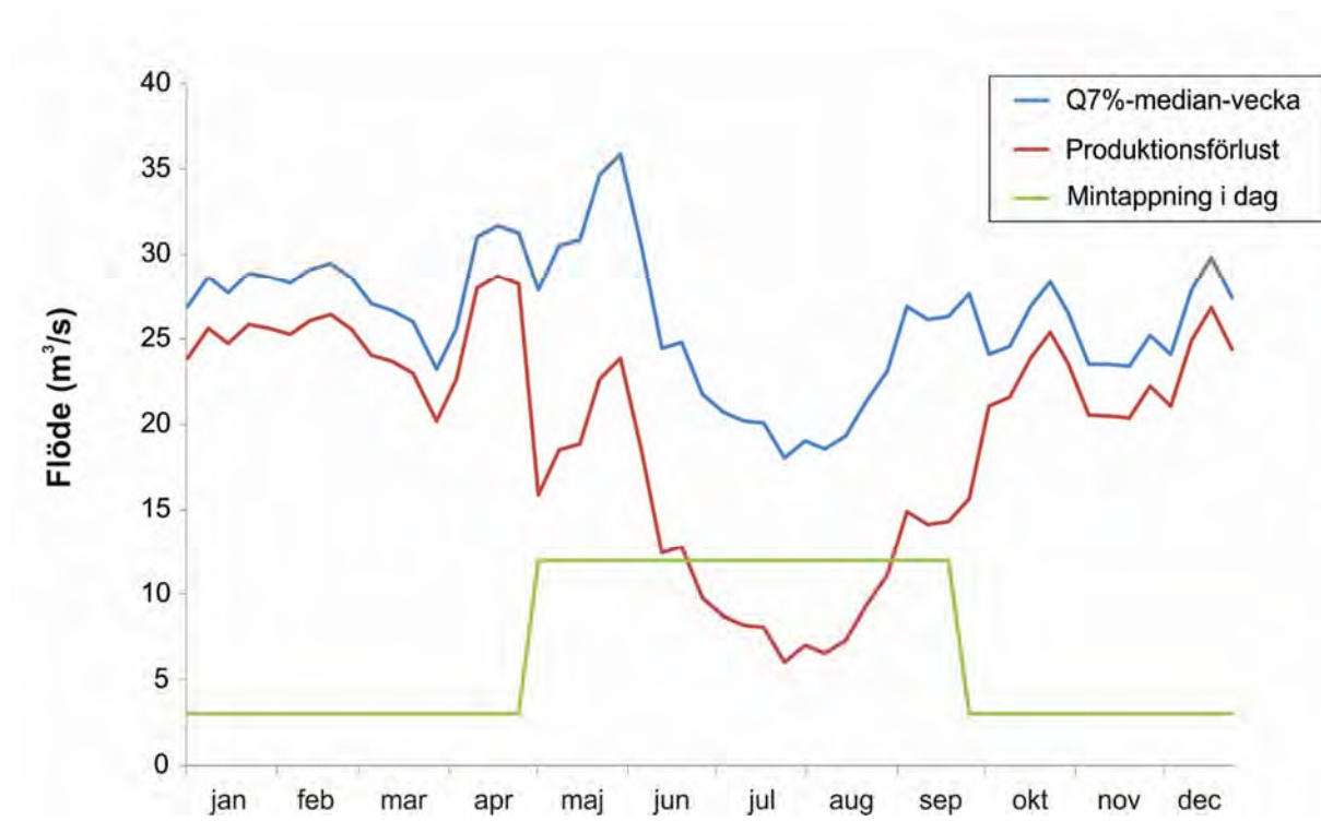
Figur 13. Exempel på mintappning i Kungsådran vid Älvkarleby kraftverk motsvarande 7 % av det totala medianflödet 2011-2015 (blå linje). Motsvarande medianproduktionsförlust för perioden illustreras av den nedre röda linjen och dagens mintappning illustreras av grön linje. Flödesdata från Vattenfall (2017).
