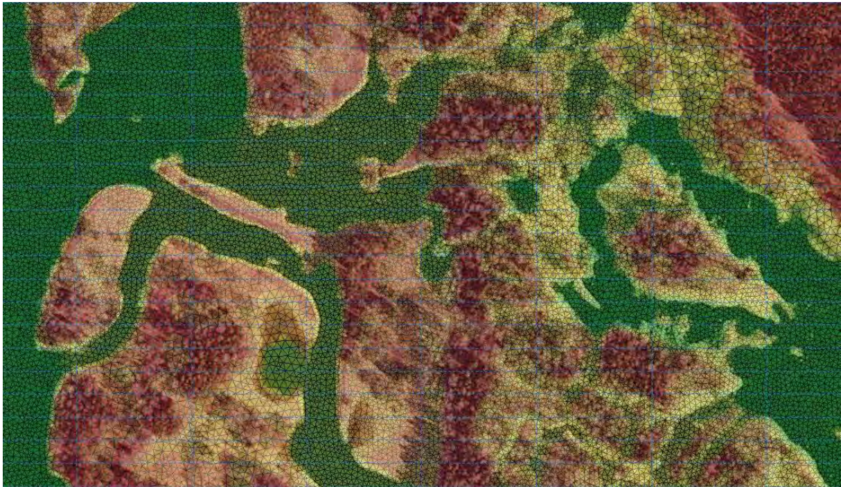
Figur 3. Ett detaljerat utsnitt ur modellområdet där ett exempel på beräkningsnätverket visas.
