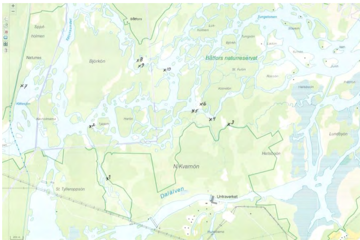
Figur 5a. Placering för tryckgivare använda i kalibreringen av modellen för lägen uppströms i området. I Figur 5b visas lägen nedströms i området.
