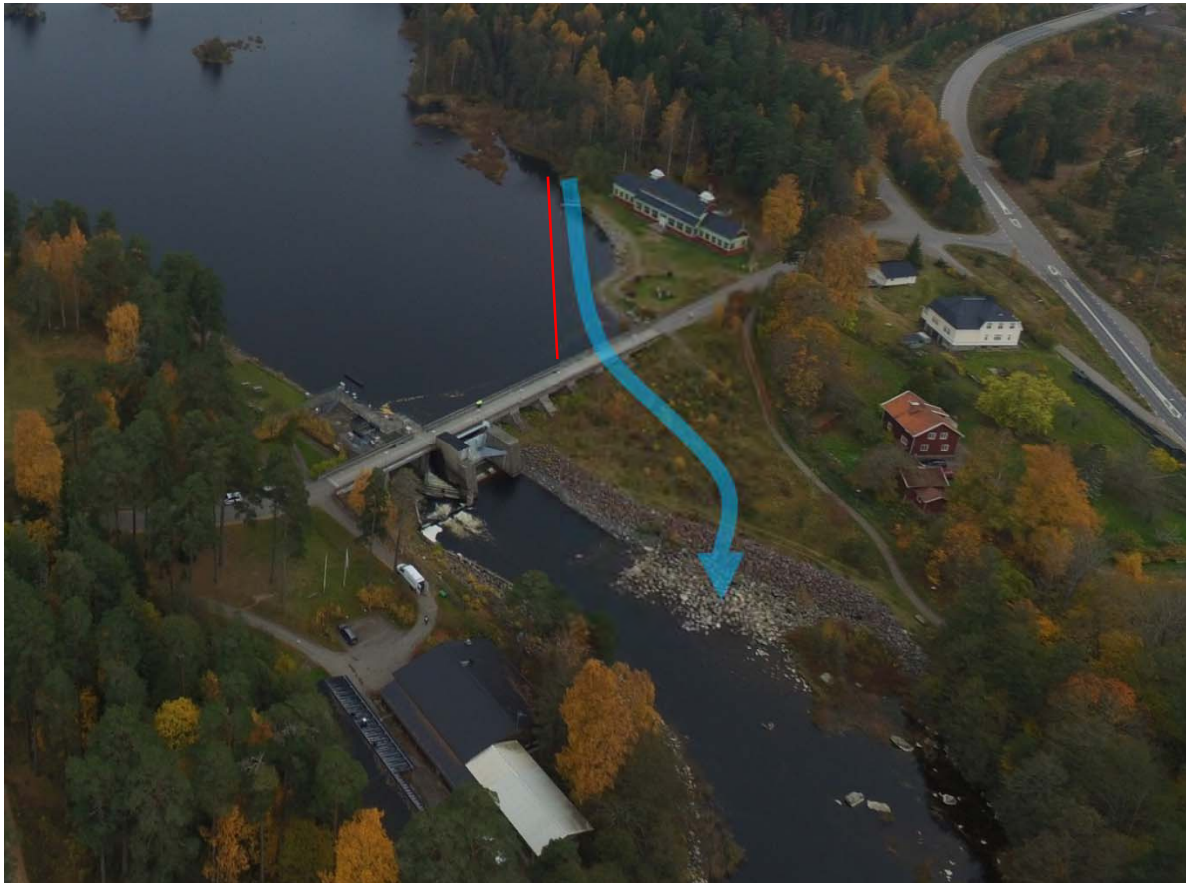
Figur 15. Principskiss över föreslagen dragning av spont (röd) och ny naturligliknande fiskväg (blå) vid Kungsådrans utskovsdamm. Norconsult 2017.
