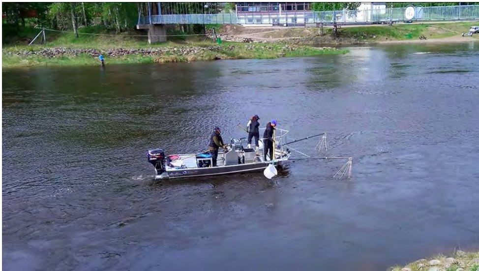
Bild 2. Elfiskebåt av typ light duty SR-16E, här under elfiske i Älvkarleby (foto: Jonas Engberg).
