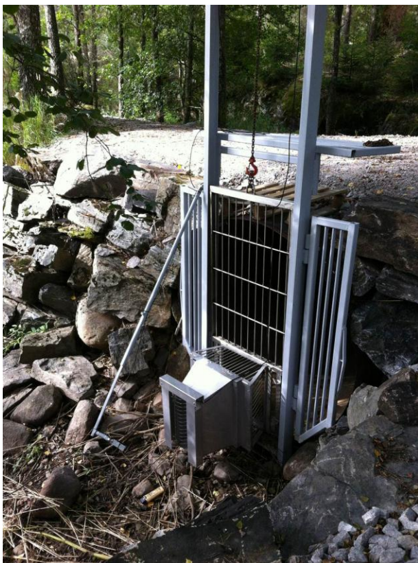
Foto 4. 2013-08-29. Fiskräknaren är monterad vid järnkulverten som binder samman dammen och ravinen. Det låga vattenståndet i dammen gör dock att fiskräknaren och fiskvägen vid tidpunkten för fotografiet inte är vattenförande.
