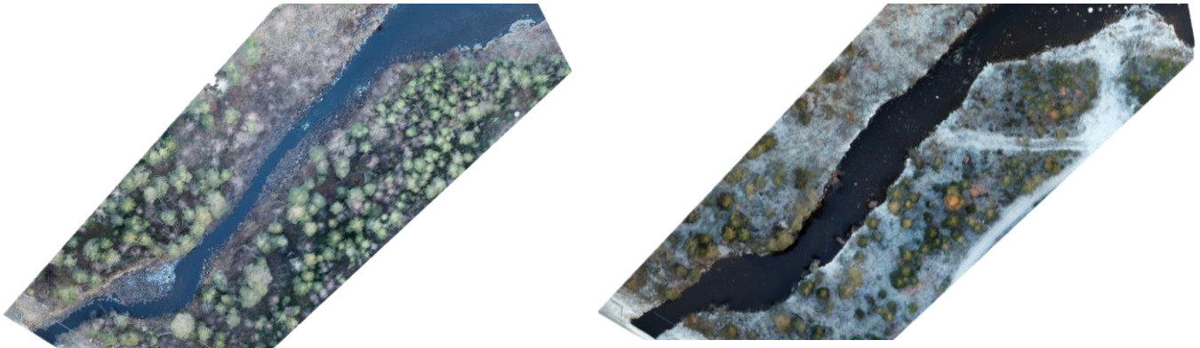
Figur 8 Återställning av flottledsrensningar i Linabäckens mynning. Vänster bild är drönarfoto före åtgärd och höger bild efter åtgärd, taget på senhösten. Foto: Länsstyrelsen
