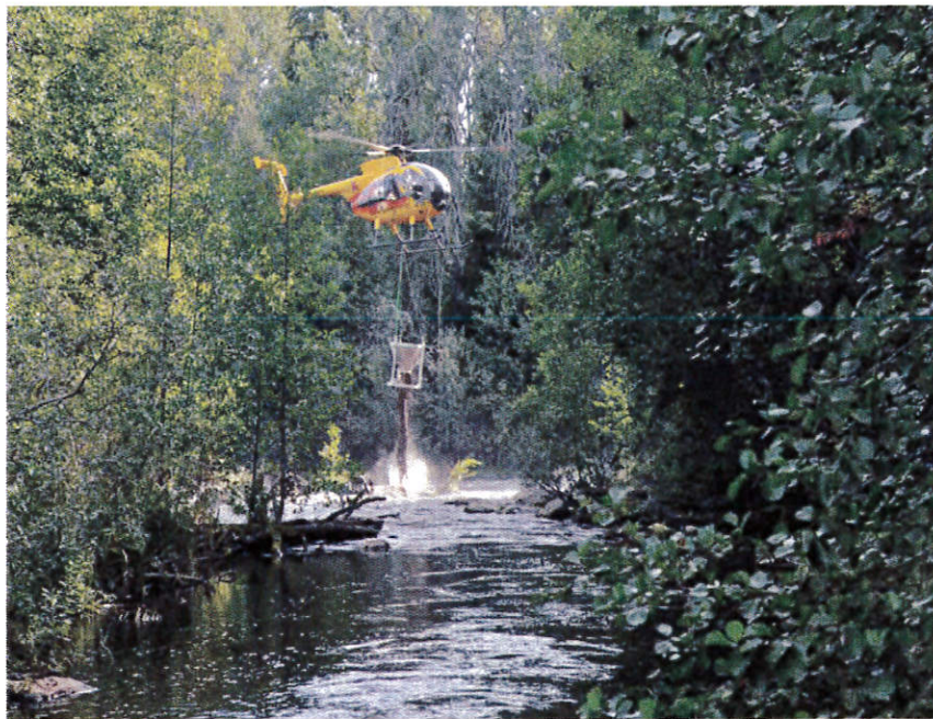
Helikopter släpper ett halvt ton lekgrus med meterprecision i en sidofåra i Bredforsen. Foto Johan Persson.
