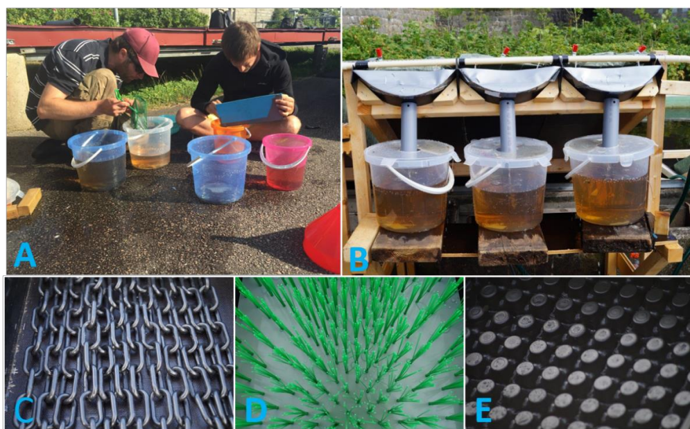
Figur 2. A) Mätning och räkning av ålyngel, B) en uppsamlingshink för respektive substrat/bana, C) Plastkätting, D) Fish Pass™, E) D-25.
