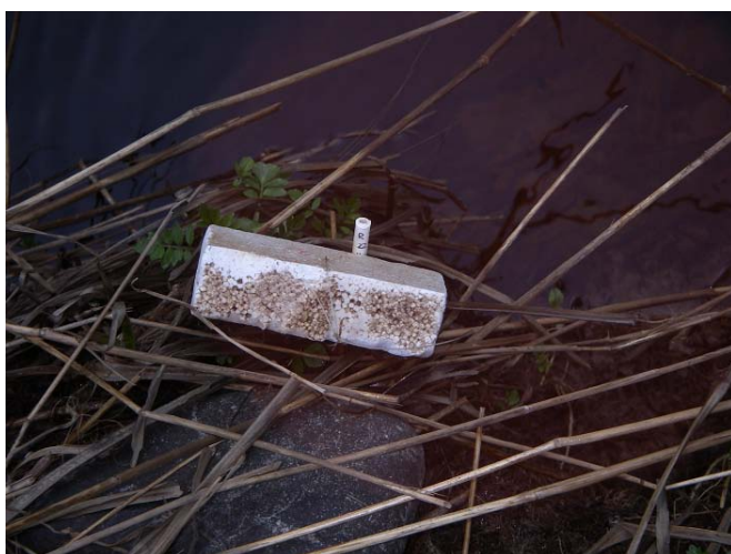
Figur 8: Frigolitklossar fästes med hjälp av fiskelina och lekare i anslutning till varje provyta. Varje kloss vägdes före och efter utsättning. Syftet var att få ett mått på den fysiska störning (=erosion av frigoliten) förändrade vattenståndsvärderingar medför (till skillnad från ren översvämningseffekt).
