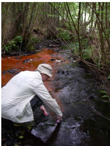
Figur 6: Vattnets flödes hastighet i de olika delområdena mättes med hjälp av koncentrationen av färgämnet Rhodamin i vattnet. Genom sådana mätningar kan man räkna ut hur snabbt vattnet flödar mellan två punkter.
