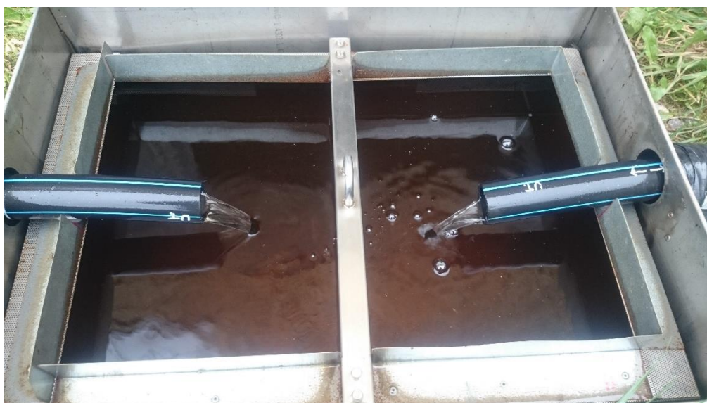
Bild 7. Det gemensamma uppsamlingskärlet utan lock. Ålynglen hamnar i en nätinsats (perforerad plåtlåda) som sedan tas upp ur det större kärlet vid vittjning.
