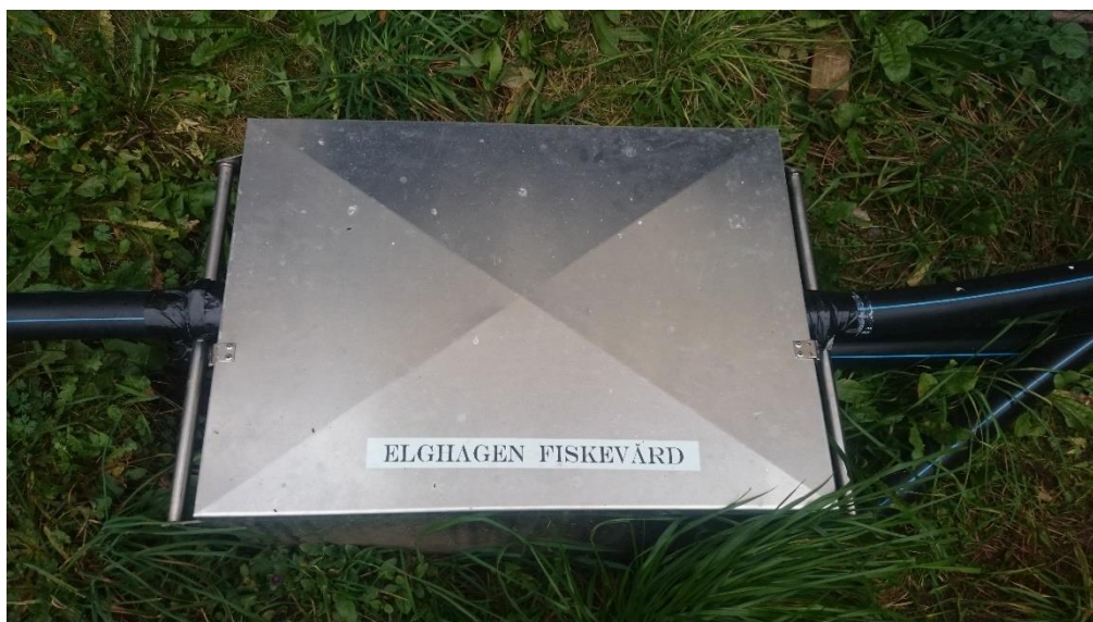
Bild 6. Det gemensamma uppsamlingskärlet med låsbart lock. Observera de två sammanlänkingsrören från höger och vänster.
