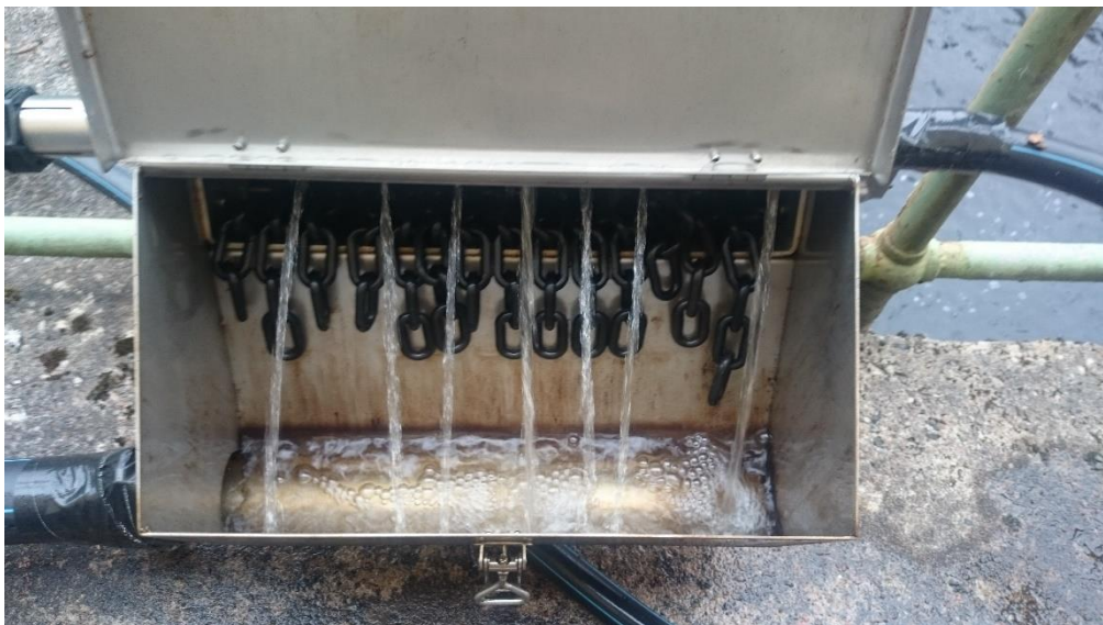
Bild 5. Det initiala uppsamlingskärlet med öppet lock. I nedre vänster hörn ses sammanlänkningsröret som leder till det gemensamma uppsamlingskärlet.
