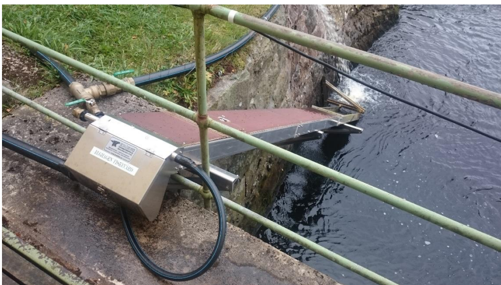
Bild 3. Ålyngeluppsamlare vid Pos. A och sammanlänkingsrör
