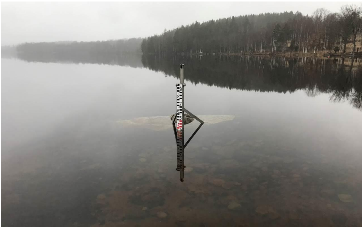
Bild 6. En ny pegel samt automatisk nivågivare med GPRS-uppkoppling installerades i sjön i samband med åtgärden, för att enklare kunna hålla koll på sjöns ”nya” hydrologiska regim.
