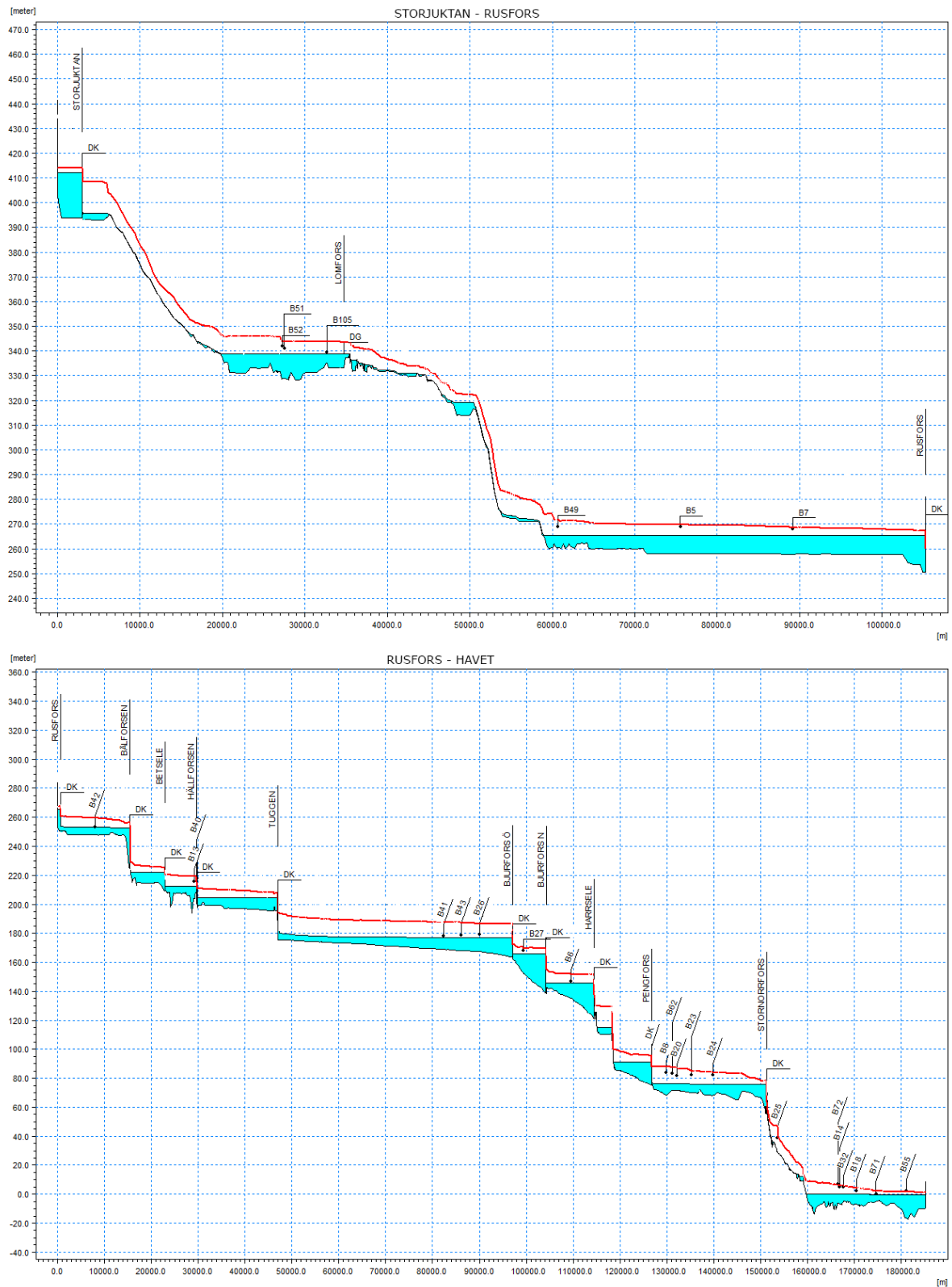
Figur 54. Fallhöjdsprofiler för Umeälven (Umeälvens vattenregleringsföretag 2014).
